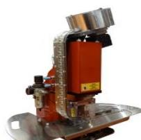
GHOST EVO: macchina automatica, funzionamento elettro-pneumatico. Il modello standard viene fornito con pedale. Fornita di stand di supporto montato su ruote. Dotata di puntatore laser per applicazioni precise. Tavolo opzionale per supporto banner. Diametro occhielli applicabile: 12 mm. Profondità di passaggio 55 mm (materiali rigidi) - 80 mm (materiali flessibili).
